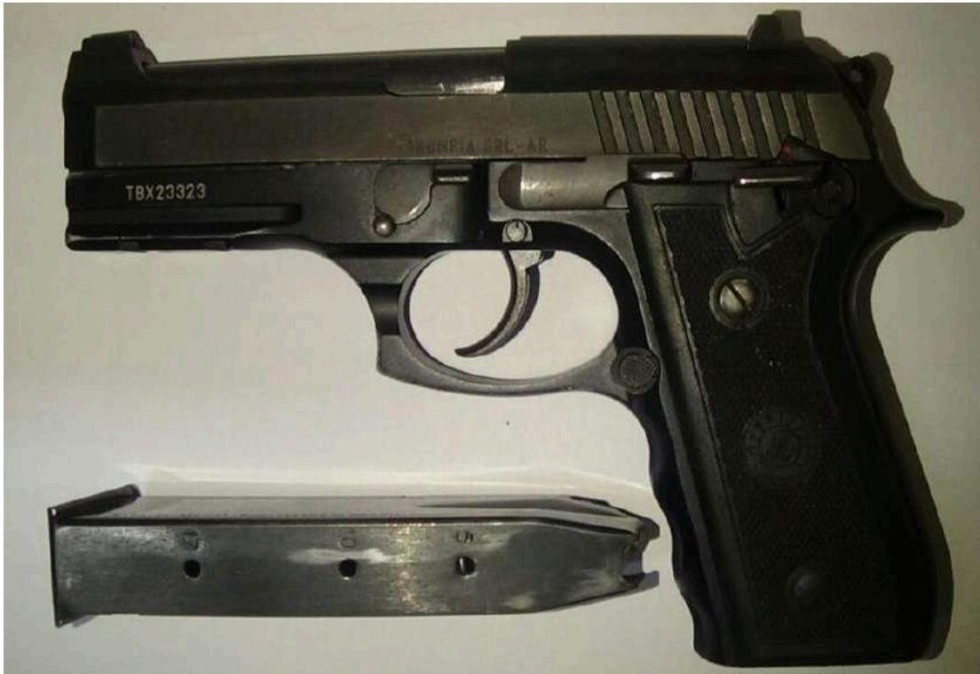
Este modelo de pistola Taurus cuenta con distintos dispositivos de seguridad, la traba del percutor queda permanentemente bloqueando el desplazamiento del mismo hacia el frente, impidiendo disparos caso suceda una caída del arma. La traba del percutor solamente es liberada en la etapa final del accionamiento del disparador, liberando el desplazamiento del percutor.
